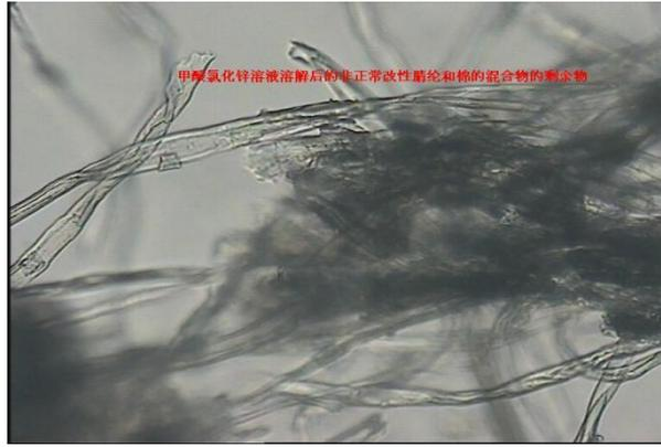
图2 甲酸/氯化锌法溶解后的剩余纤维
